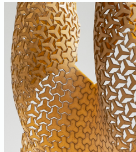
Beispiel-Tool: auxetrische Strukturen geschnitten in Naturlatex link zum Online Editor Auxetric Generator V.0.12: © Johannes Kiel 2024 (Prototyp: noch nicht für Smartphone optimiert)
